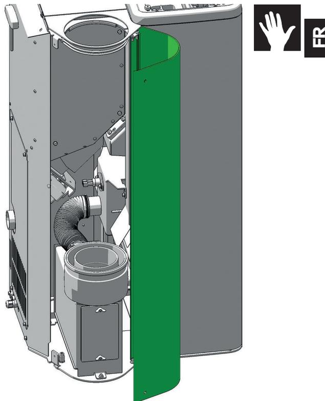
Devissez les écrous à oreilles du couvercle de nettoyage. Tirez le tiroir à cendres dehors et videz-le. Aspirez le séparateur des cendres. Aspirez aussi les résidus de combustion du boîtier de ventilateur.
