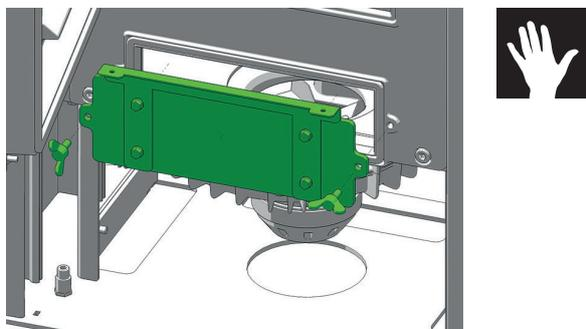
Aspirez les résidus de combustion des conduits des fumées et de la boîte du ventilateur.
