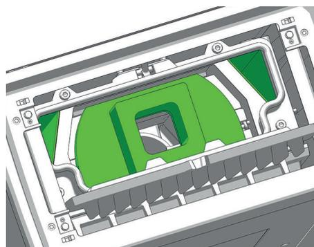
Ouvrez la porte de la chambre de combustion et dévissez les deux vis à oreille.
