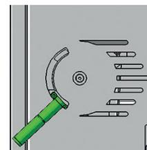
L'acheminement de l'air est indispensable pour la phase d'allumage. La position allumage doit uniquement être utilisée pour l'allumage et pour la réalimentation.
