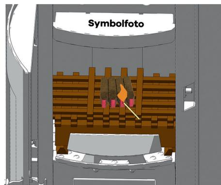
Allumez à présent l'allume-feu (ou le papier non enduit) et refermez la porte du foyer. Un allumage correct permet d'éviter un développement de fumée excessif lors de la procédure d'allumage.
