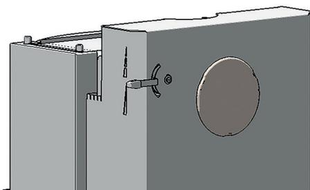
Remplacez la tubulure des gaz de fumée par le couvercle d'arrière.
