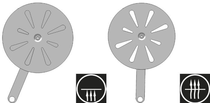
La grille oscillante doit en principe rester ouverte durant le fonctionnement du poêle.
