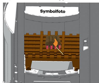
3. Allumez l'allume-feu (ou le papier non enduit) et refermez la porte du foyer. Un « allumage correct » permet d'éviter un développement de fumée excessif lors de la procédure.
