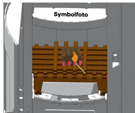
Allumez à présent l'allume-feu (ou le papier non enduit) et refermez la porte du foyer. Un allumage correct permet d'éviter un développement de fumée excessif lors de la procédure d'allumage.
