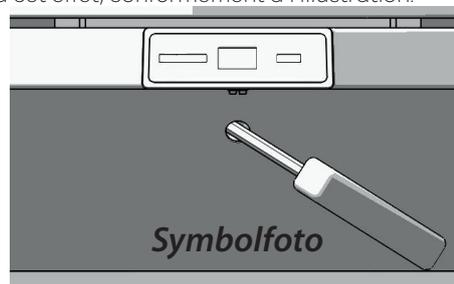
Une rotation dans le sens des aiguilles d'une montre entraîne l'ouverture des volets d'air. Une rotation dans le sens inverse des aiguilles d'une montre entraîne leur fermeture.
