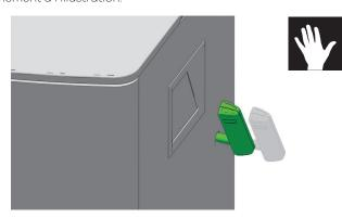
Tournez la clé dans le sens des aiguilles d'une montre jusqu'à ce le clapet soit fermé.
