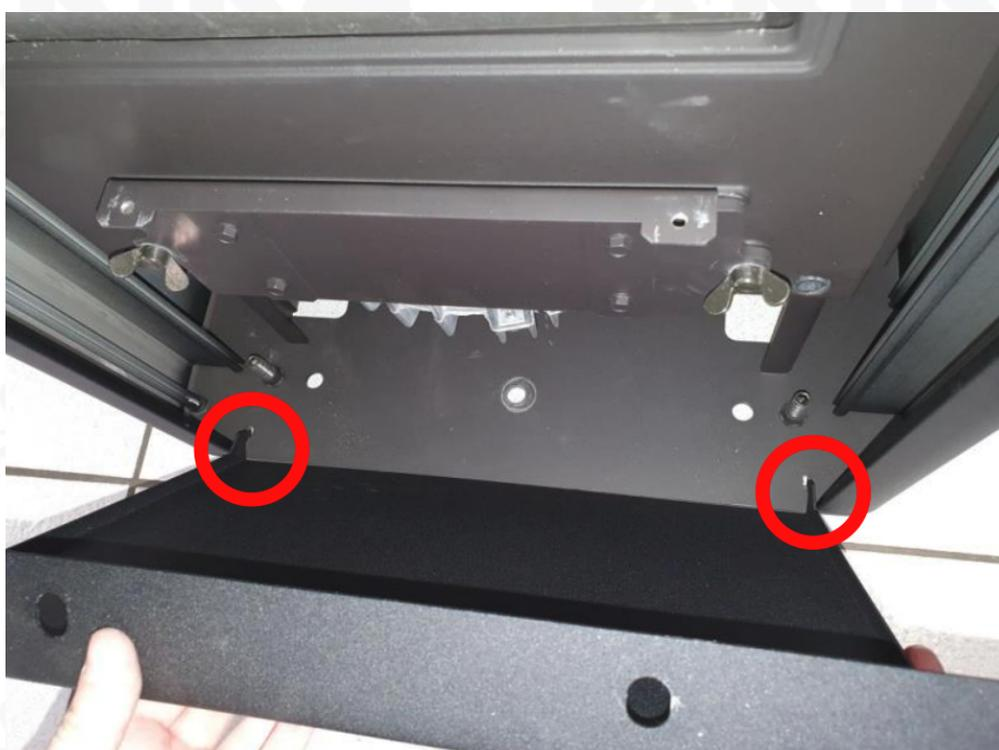
Pour remettre la plaque, mettre correctement les petits crochets dans les trous
