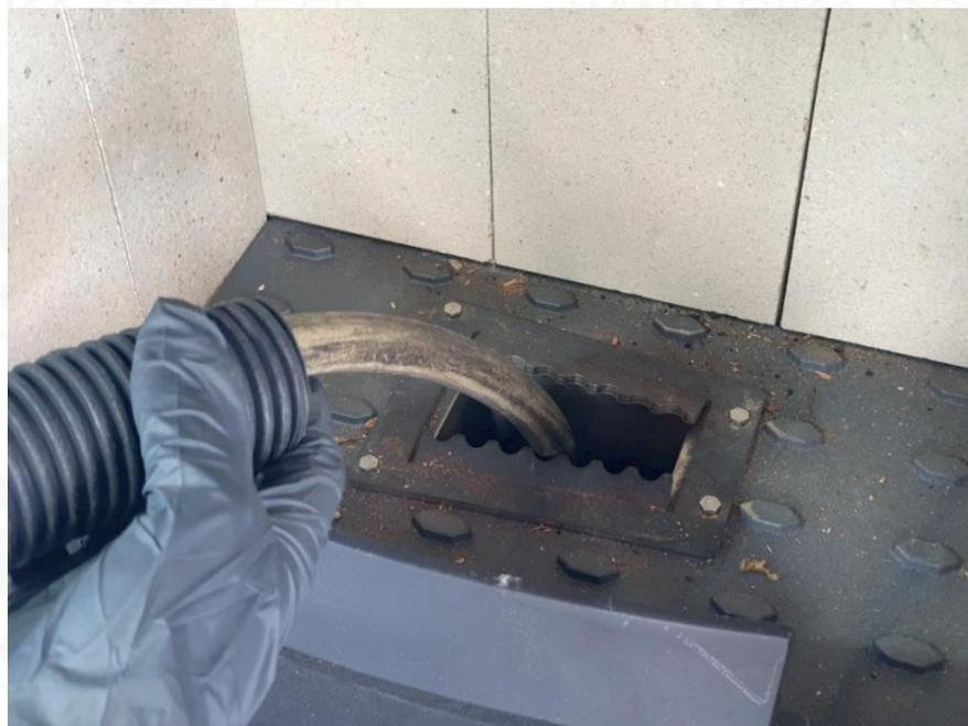
Souvent les embouts des aspirateurs ne passe pas, il faut s'aider d'un tuyau d'arrosage pour bien s'aspirer la grille basculante
